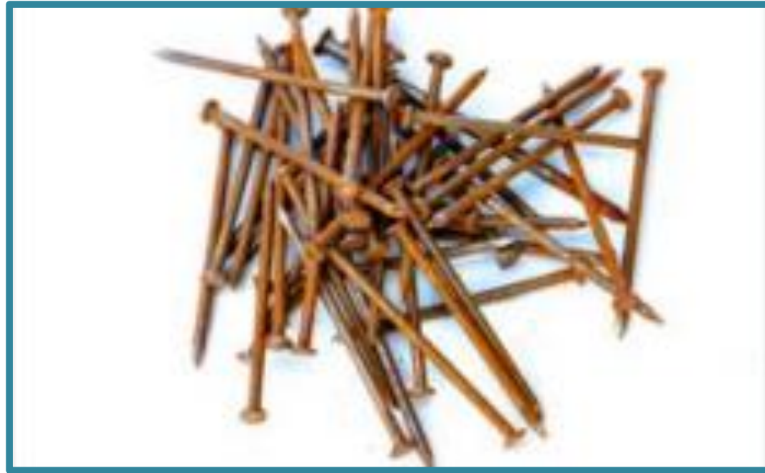
การเกิดสนิมของตะปูเหล็ก การเปลี่ยนแปลงทางเคมี
